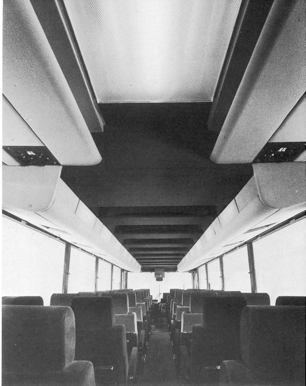
Interno del pullman dove si nota subito la massima visibilità. L'effetto tunnel è annullato da mensole trasversali e dal rialzo del soffitto nella parte posteriore del veicolo.
