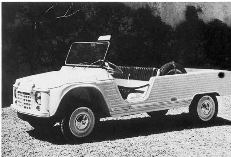
Carrozzeria per la Mehari Citroën di ABS termoformato.
