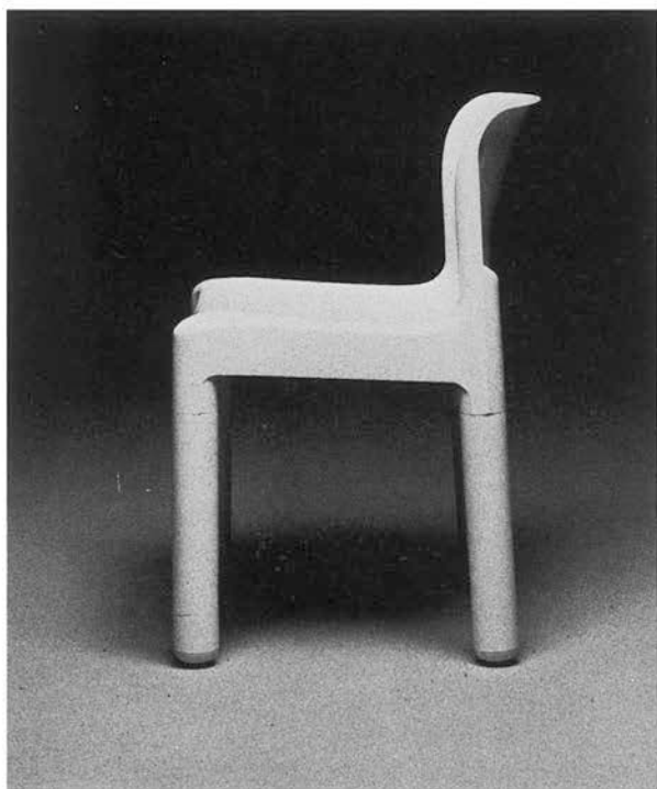
Sedia di polipropilene stampata a iniezione. Le gambe sono smontabili per ridurre lo spazio nel trasporto e nel magazzino. Design Carlo Bartoli, produzione Kartell.
