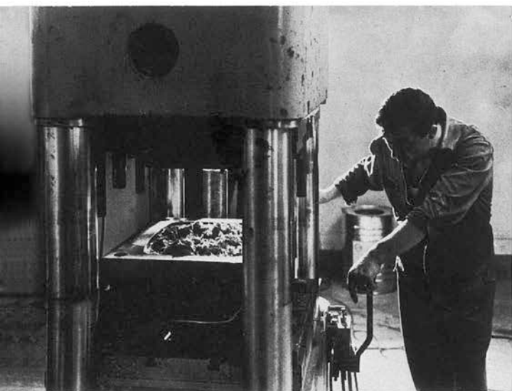
In questo stampo a compressione è visibile l'impasto di resina e fibre di vetro.
