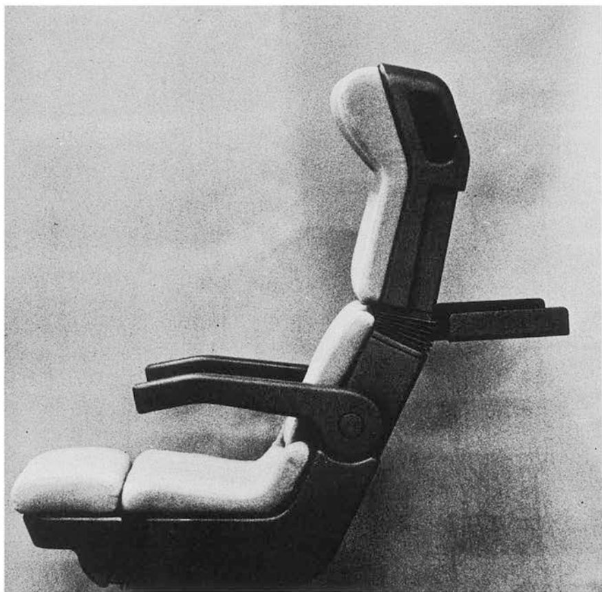
Il modello al vero del sedile nel quale si nota anche il ribaltamento del tavolino, per i posti in aereo. Notare anche la maniglia incassata nella scocca, così da non creare ingombri.
