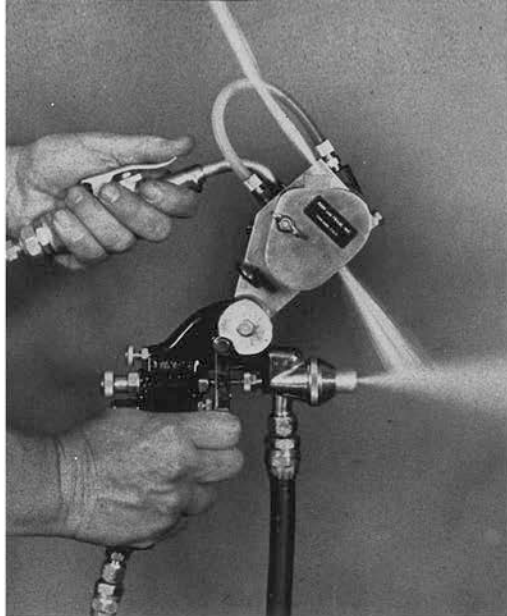
Gli spruzzatori della resina con catalizzatore e delle fibre di vetro.
